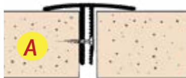
B Profil de jonction pour panneaux de 16 à 19 mm
