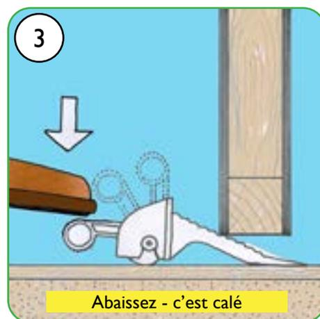
Notre nouveau SYSTEMCAL-porte est très simple d'utilisation. Il suffit de positionner le coin dans le jeu de la porte et d'abaisser le levier pour assurer le blocage.
